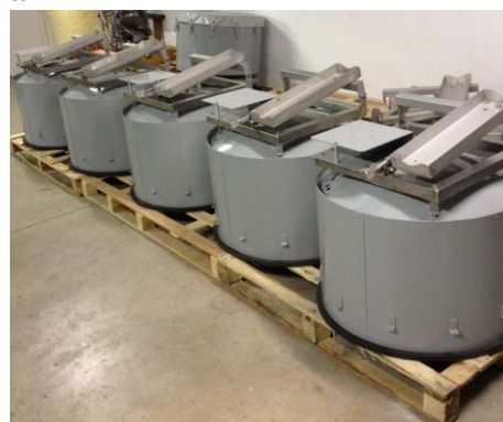
Assemblage final des antennes Furtives Blindées Dual-Hélix
